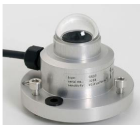
Figura 5.6: Piranômetro para medida de radiação solar global (Direct Industry).
