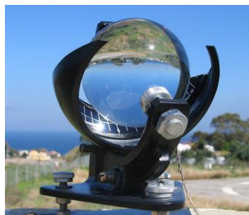
Figura 5.7: Heliógrafo mede a duração da insolação (Wikipédia, 2012).
