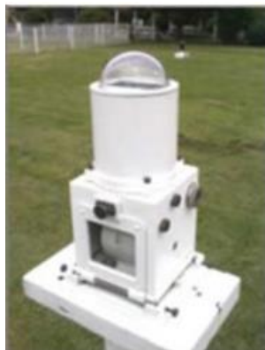
Figura 5.5: Actinógrafo, instrumento para medição da radiação global (Meteorologia).
